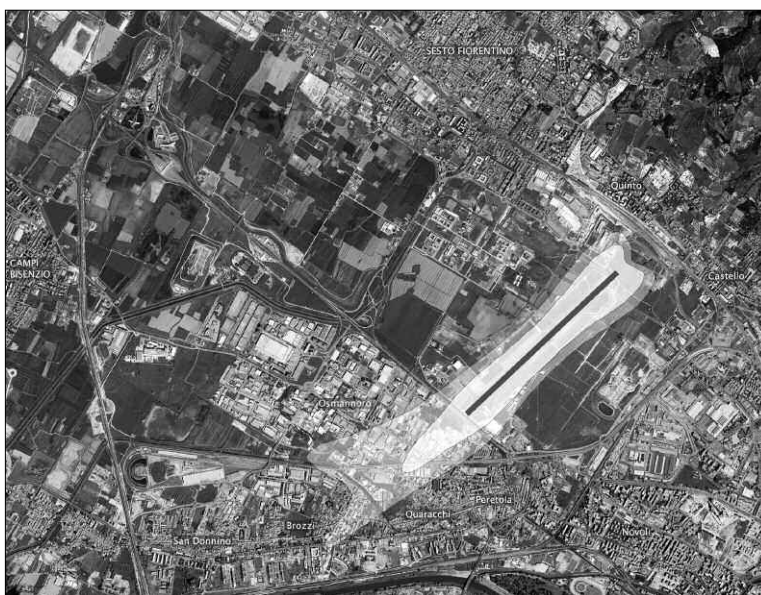
Nelle immagini sono rappresentate le impronte di rumore dei 65 decibel, limite di legge per le aree residenziali (curva interna) e dei 60 decibel (curva esterna). Sopra: la situazione con il mantenimento dell'orientamento attuale. Sotto: la situazione prevista nella configurazione con la nuova pista 12/30 nello scenario di sviluppo dello scalo a quattro milioni di passeggeri e 45.000 movimenti. Nel nuovo assetto entrambe le curve si mantengono lontane da tutte le aree abitate.
