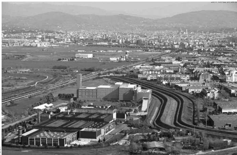
In questo fotomontaggio si vede l'anticipazione grafica del termovalorizzatore di Case Passerini (in primo piano) e sullo sfondo l'aeroporto di Firenze. La pista obliqua 09/27 proposta dalla Regione Toscana punterebbe direttamente sul nuovo impianto creando un conflitto con le rotte di volo.
