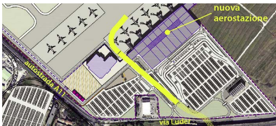
In alto: il tracciato della linea 2 della tranvia in completamento presso l'aeroporto, con la fermata in superficie dopo l'uscita dal tunnel di via Luder e il primo tratto di prosecuzione verso Sesto Fiorentino. Sopra: lo stesso tracciato riportato sul planivolumetrico del masterplan del "Vespucchi".
